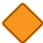
Losange orange : Avertissement de travaux
